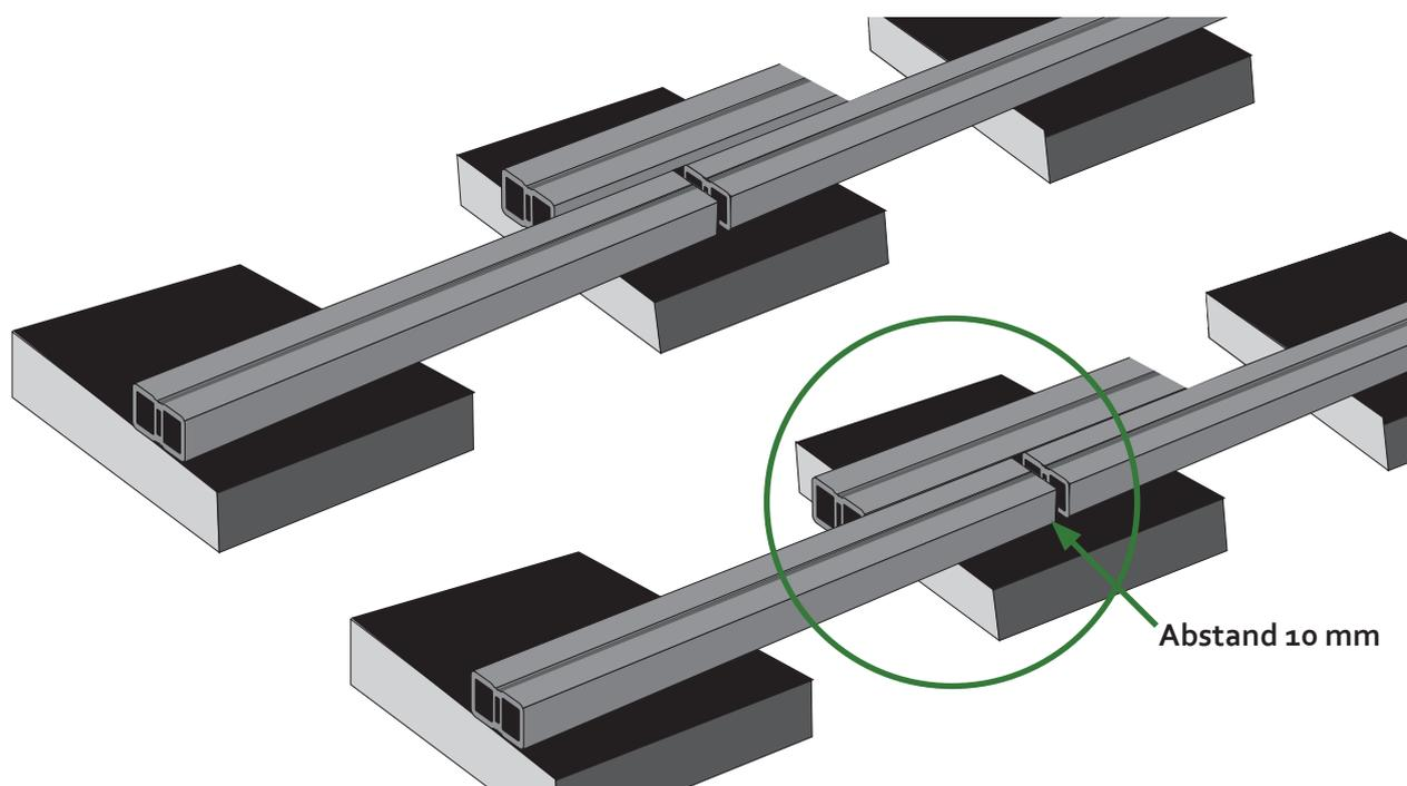
Eine andere Möglichkeit, die UK zu stoßen, ist das mittige Stoßen. Hier sollte ein Mindestabstand von 10 mm an den Stirnseiten eingehalten werden. Mittig zum Stoß ist seitlich ein Stück Unterkonstruktion anzubringen. Dieses Stück muss über eine Mindestlänge der doppelten Dielenbreite +10 cm verfügen, um dem Konstrukt ausreichend Stabilität zu geben.
