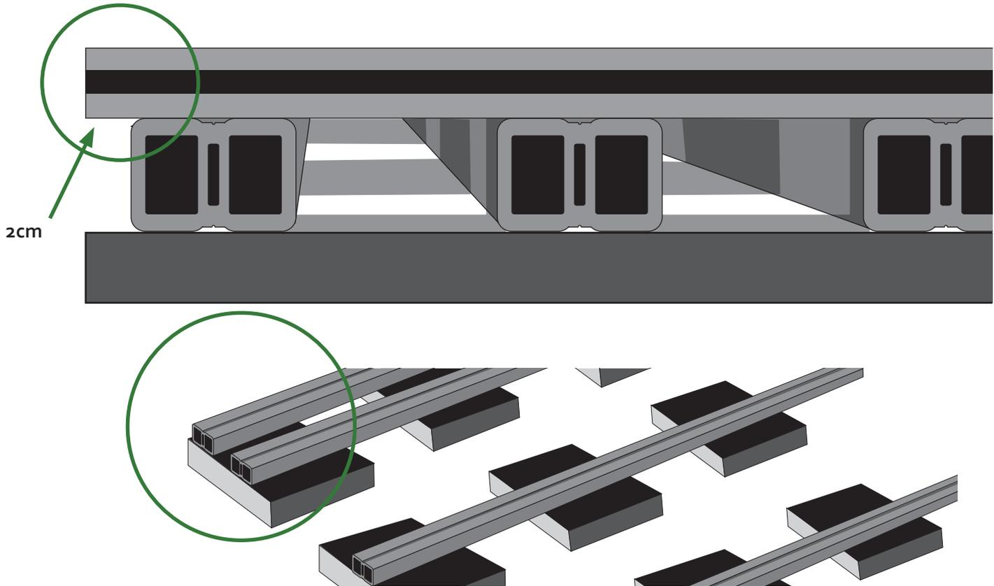
Die jeweils äußeren Unterkonstruktionen sollten, mit einem Abstand von ca. 20 cm, unbedingt doppelt verlegt werden, um eine außermittige Belastung der Betonplatten zu vermeiden.
